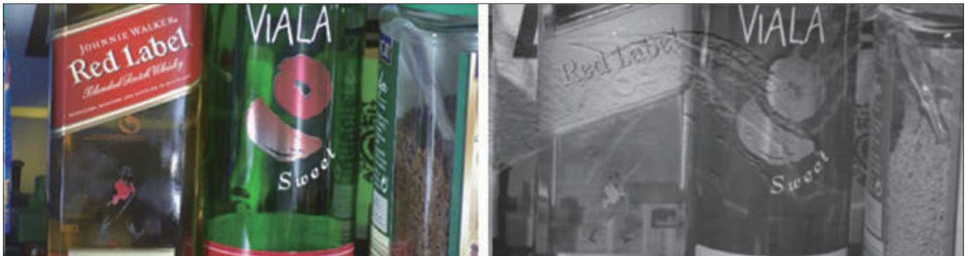
<그림2> Motorized 렌즈가 가시광선과 근적외선(NIR) 빛을 동일한 평면에 초점을 맞춘 모습으로, 음료수 검사 시뮬레이션에서 확인할 수 있다.
