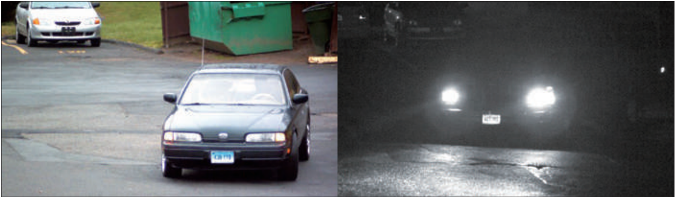
<그림5> 전동 조리개 제어를 통해 사용자는 조리개 크기를 정밀하게 제어할 수 있으며, ANPR 응용 분야에서 유용하게 사용된다.
